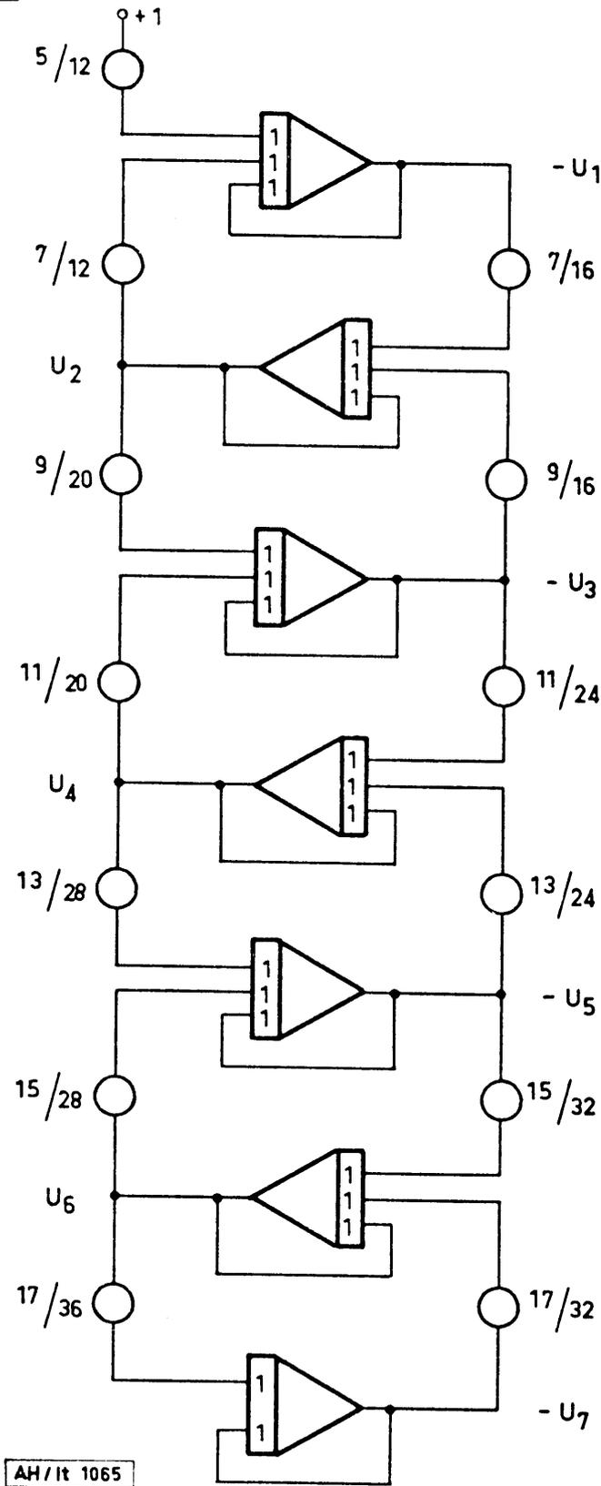
Bild 2 Rechenschaltung zur Lösung des Gleichungssystems Gl. (11)
