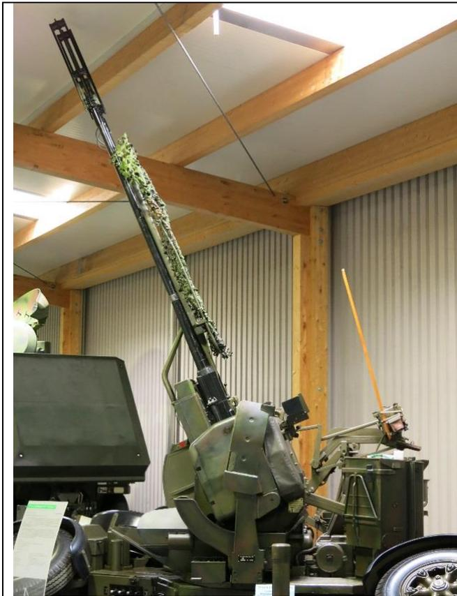
Der helle Holzstab rechts ist satt am Visierkasten befestigt: Er ist **nicht parallel** zu den Geschützrohren. Die Richtung des Visiers ist um die 8° Grad steiler, und dieser Wert hängt nicht von der Steilheit der Kanonenrohre ab.
