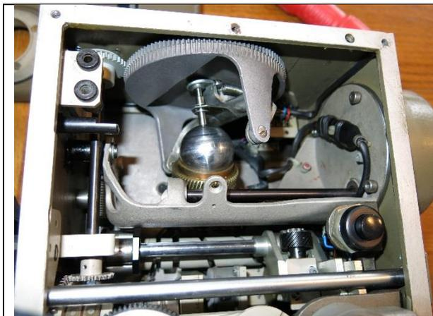
**Blick eher zum Flugzeug:** Eine blanke Eisenkugel mit komplexer Aufhängung – vier Drehachsen gehen durch den Kugelmittelpunkt! Dient der Orientierung am Himmel, siehe später. Das grosse Zahnrad im Bild ganz oben gibt die Flugrichtung an. Die grosse offene Walze ist an die Steilheit der Kanone gekoppelt. Die Kugel wird ab Erfassen des Flugzeuges magnetisch an den gezähnten Bronzetafel darunter gepresst. Rechts Druckknopf für Distanzprogramm.
