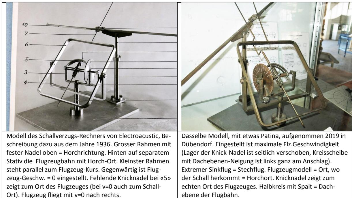
Modell des Schallverzugs-Rechners von Electroacoustic, Beschreibung dazu aus dem Jahre 1936. Grosser Rahmen mit fester Nadel oben = Horchrichtung. Hinten auf separatem Stativ die Flugzeugbahn mit Horch-Ort. Kleinster Rahmen steht parallel zum Flugzeug-Kurs. Gegenwärtig ist Flugzeug-Geschw. = 0 eingestellt. Fehlende Knicknadel bei «5» zeigt zum Ort des Flugzeuges (bei  $v=0$  auch zum Schall-Ort). Flugzeug fliegt mit  $v=0$  nach rechts.
