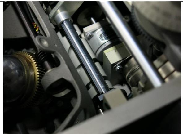
... helle lange Walze mit **Spiralrille**, welcher den Schlitten mit dem drehbaren Kreis verschiebt (s. untere Bilder). Das Differentialgetriebe ist oben, hier nicht mehr sichtbar.
