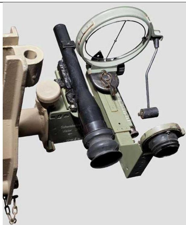
Visier mit Pendelgewicht, hier leider fixiert (rechtwinklig zur Blickrichtung) und **nicht** frei schwebend horizontal gehalten. Das Visier lässt sich mit dem Knopf rechts vorne verschieben von 50 m/s (weit) bis zu 75 m/s (nah). Das Auge bleibt fix am selben Ort (im Gegensatz zum Bild links). 20 mm Flak 38, Rheinmetall-Borsig. Hermann-Historica, Auktion 2010
