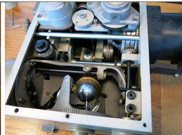
**Blickrichtung zum Richter:** Zuhinterst die beiden Knöpfe zur Einstellung von Entfernung und Geschwindigkeit. Darunter, hier nicht sichtbar, die Mechanismen zur Einstellung des Vorhaltes und der Flugrichtung. Ganz rechts aussen die Optik und gleich innen die beiden Schleifringe für den Lampenstrom (Lampe und Vorhalt-Anzeige bewegen sich als Karussell um die Linsen-Achse, 360°). Rechts vorne Anschluss zur Beleuchtung des Erdzielfernrohres.
