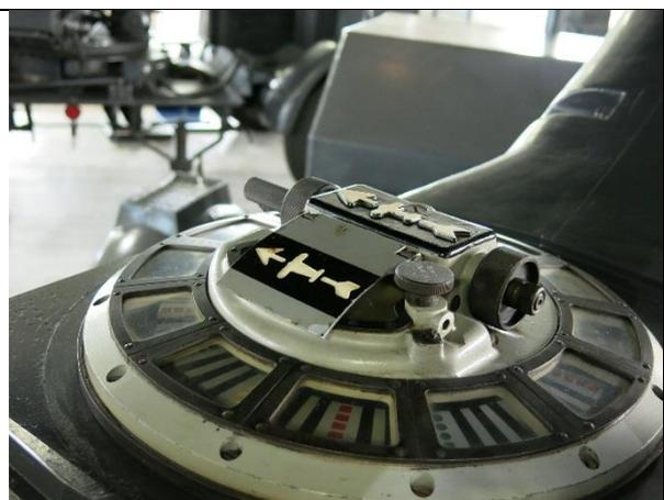
In der Mitte der grossen Traggabel sitzt das Flugrichtungs-Karussell, vom Bediener des Rechners auf Stillstand eingeregelt. Unter den sich drehenden Fenstern ist eine weitere, sich drehende Scheibe mit farbigen Strich-Markierungen. Durchmesser 35 cm. Die echte Flugrichtung wird vom Pfeil angezeigt. Hasler und Xamax haben an der Konstruktion des Rechners mitgearbeitet.
