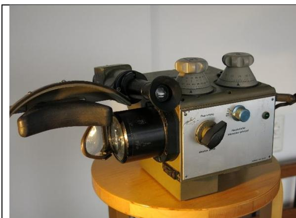
Ganz links die Stirnstütze des Richters (div. grossflächige Sonnenfilter fehlen). Rechts daneben die massive, dunkle Optik, mit der die Visier-Daten auf den schräg stehenden, durchsichtigen Spiegel projiziert werden. Das rechte Auge des Schützen sieht durch den Spiegel zum Flugzeug und «sieht» dabei den Ziel- und Treffpunkt im Himmel.
