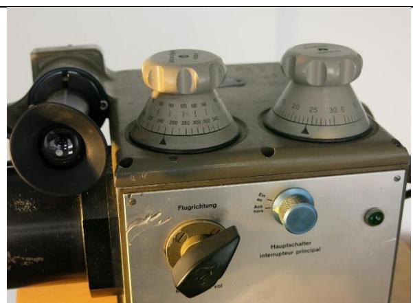
Links über der Optik das Erdziel-Fernrohr. Oben auf dem Gehäuse zwei Köpfe zur Einstellung von geschätzter Geschwindigkeit (links) und Distanz (rechts), auch vom Gehilfen einstellbar (zweite Ablesemarke rechts hinten). Vorne der schwarze Drehhebel zur Wahl der ungefähren Flugrichtung, sowie die Einstellung der Visier-Beleuchtung.
