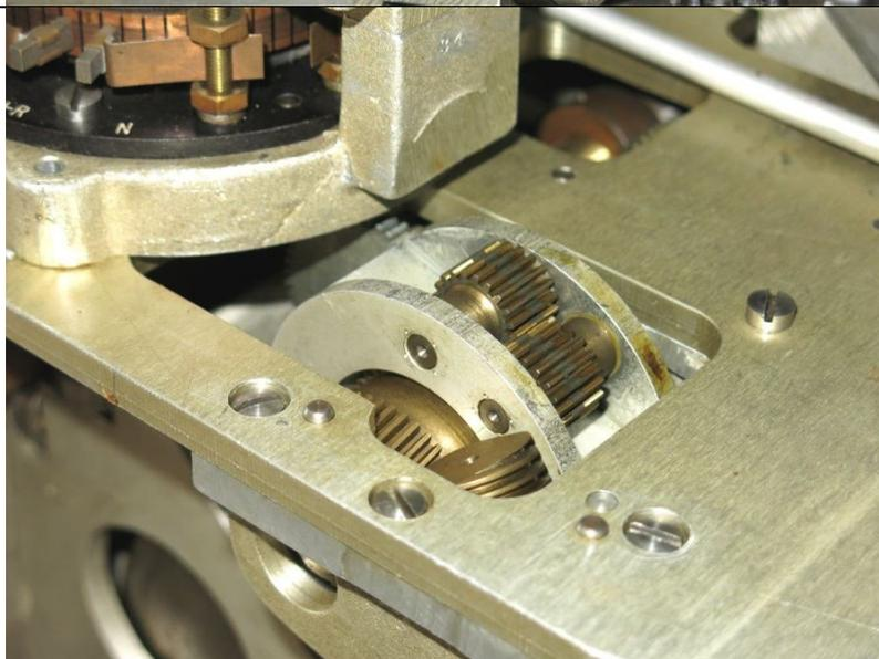
Ein **Additionsgetriebe**, das einfacher herzustellen ist als das klassische Differentialgetriebe.
