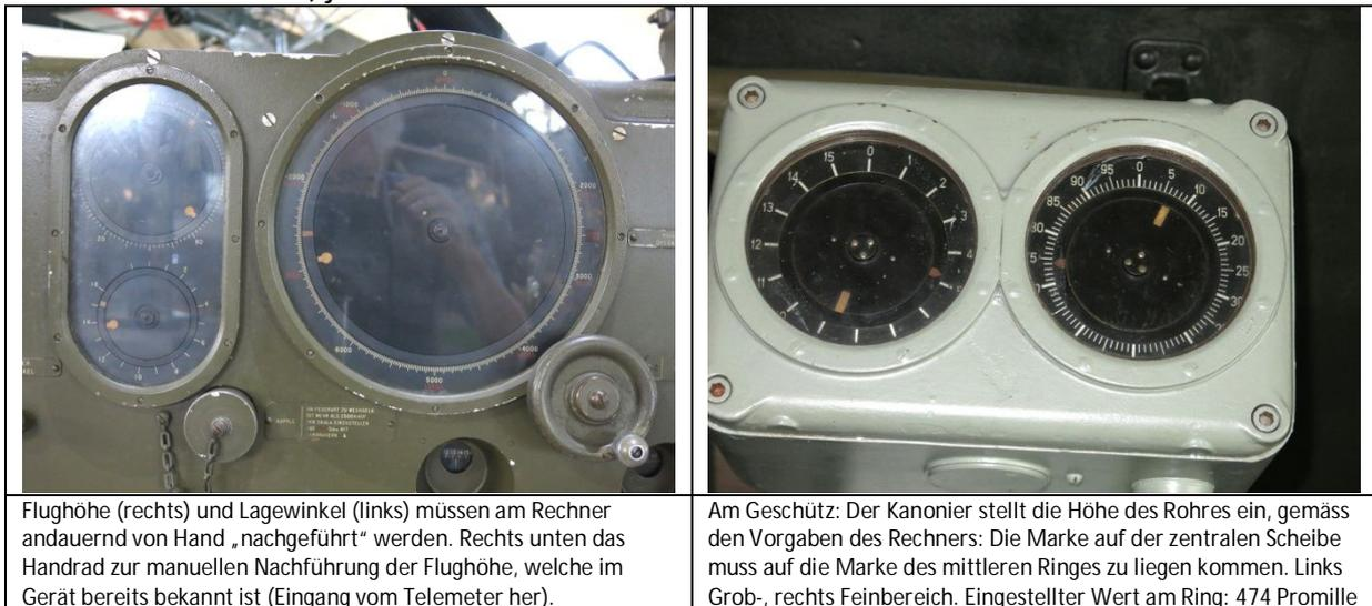
Flughöhe (rechts) und Lagewinkel (links) müssen am Rechner andauernd von Hand „nachgeführt“ werden. Rechts unten das Handrad zur manuellen Nachführung der Flughöhe, welche im Gerät bereits bekannt ist (Eingang vom Telemeter her).
