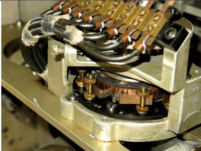
Unten, auf beweglichem Rad: Elektrische Kontakte, mit denen sich die beiden **Nachführmotoren** selber die passende Eingangsvariable suchen (Koordinaten Nord/Süd oder Ost/West), nach denen sie die Ausgänge (Distanz, Azimut) nachregeln.
