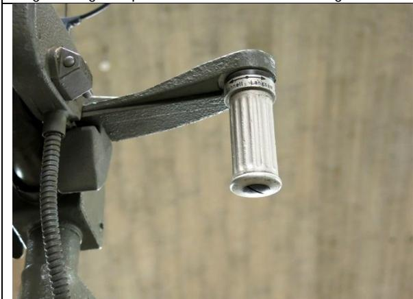
1248 Am Handgriff rechts kann der Richter durch eine Drehbewegung „schneller“ oder „langsamer“ anfordern, bis die Winkelgeschwindigkeit stimmt; infolge Entfernung oder Annäherung des Flugzeuges wird sie sich immer verändern.
