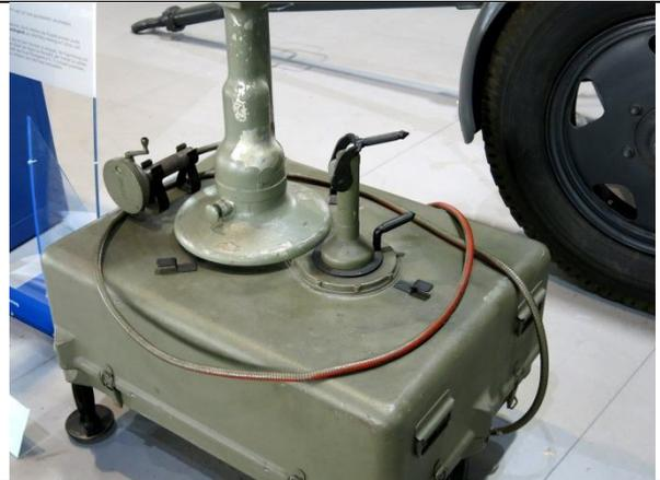
1284 Rechts die beiden von Hand einzustellenden Flugrichtungspfeile, für die **Distanzkorrektur**: einer zeigt stets zum Flugzeug, einer wird auf die ungefähre Flugrichtung (Kompasskurs) eingestellt. Der obere Pfeil lässt sich in fünf oder sechs Stufen in der Höhe anheben oder absenken, für den geschätzten Steig- oder Sinkflug. Diese Einstellungen erfolgen mit geringer Genauigkeit.
