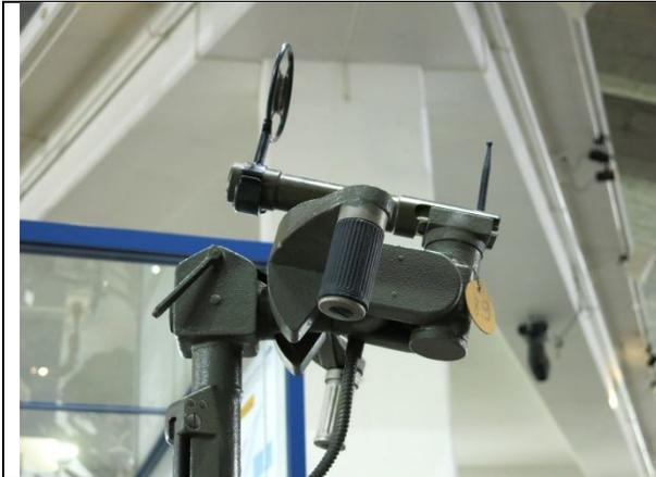
1247 Aufhängung des (ehemals) Fernrohres. Die Seitenbewegung von Hand bewegt die ganze äussere Säule; das Kommandogerät steuert die **Winkelgeschwindigkeit** des Fernrohres mit einer Stange innerhalb der Säule. Möglich von Hand ist auch die Bewegung „links tief, rechts hoch“, um die Achse der Winkelgeschwindigkeit der scheinbaren Flugrichtung anzupassen. Blau ist nur der Hintergrund.
