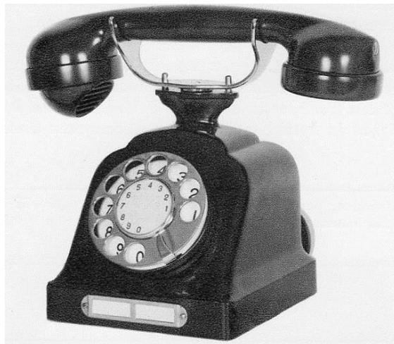
„Der 1927 von der Hasler AG neu entwickelte und dann von der Obertelegraphendirektion (OTD) als Normaltyp eingeführte Tischtelephonapparat“ beruht auf der Impulswähltechnik. Die Impulse steuern in den automatischen Zentralen eine grosse Zahl von Magnet-Wählern an. Weggelassen aus ästhetischen Gründen wird in diesem historischen Bild das Kabel zum Hörer. Hinten sind knapp die grossen Glocken sichtbar. Aus Ref. 3, p.78
