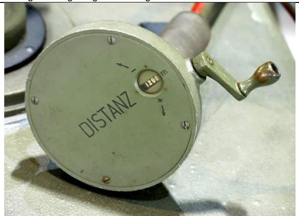
1245 Distanztrommel: Vom Telemeter her wird die Distanz zum Flugzeug zugerufen, hier wird die Distanz eingedreht und über ein ca. 3 m langes „mechanisches Kabel“ ins KdoGt eingeführt. Stufung der Zahlenanzeige: 100 m
